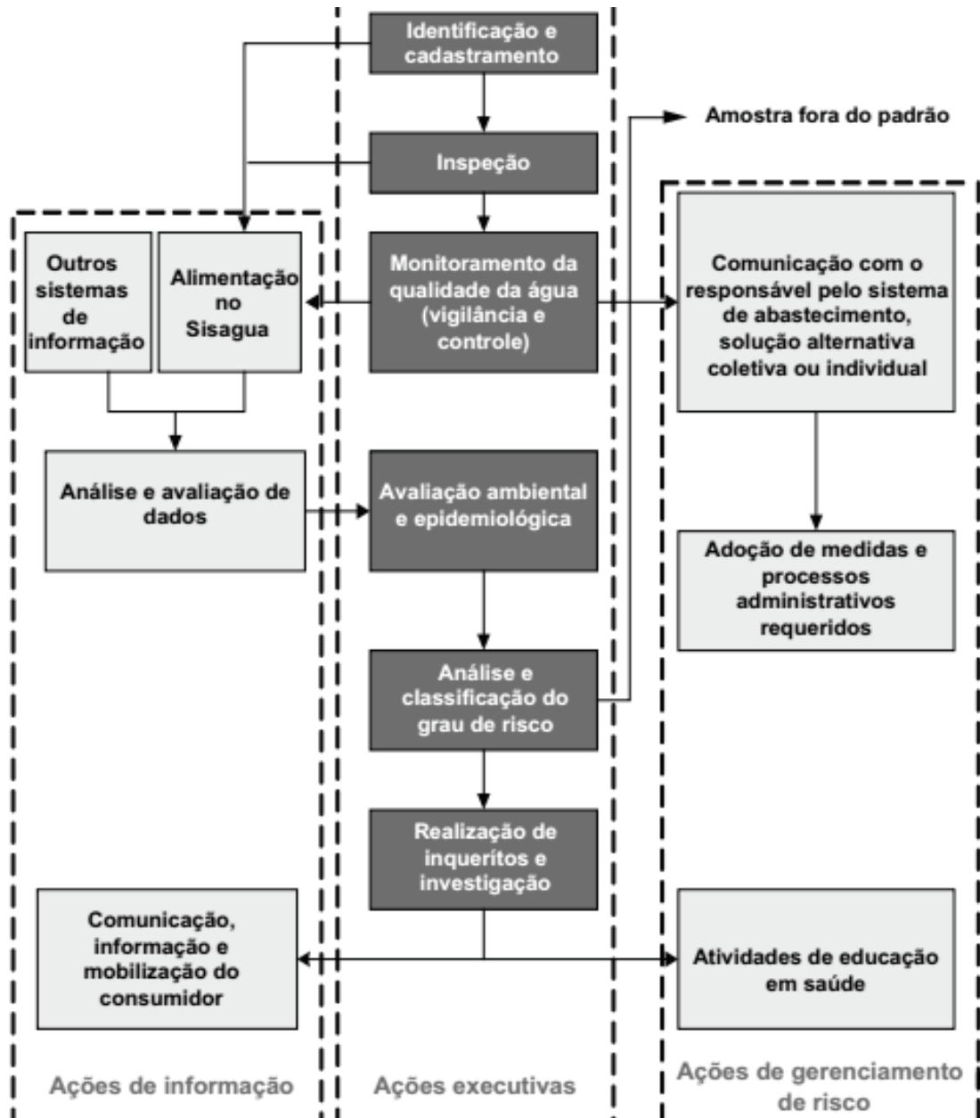
Figura 16: Ações básicas para operacionalização da vigilância da qualidade da água para consumo humano
