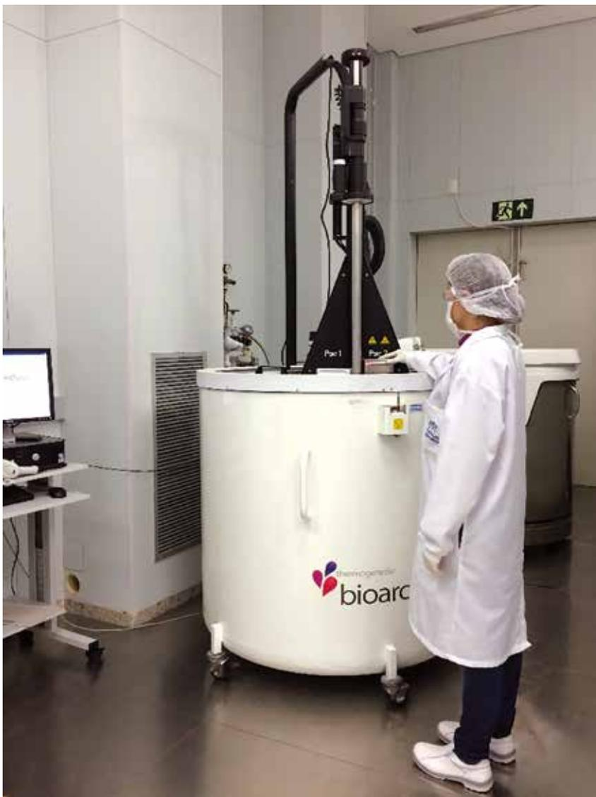
Figura 2: Equipamento utilizado para congelar e armazenar as bolsas contendo Sangue de Cordão Umbilical e Placentário para uso clínico.
